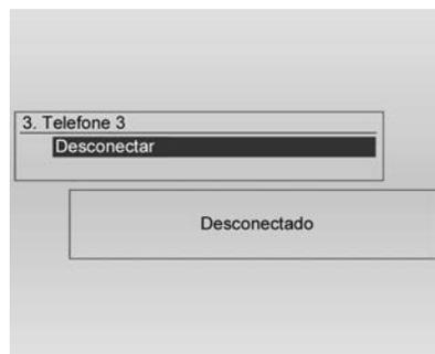
Desconecte o dispositivo Bluetooth atualmente conectado. Na tela da lista de dispositivos, selecione o dispositivo conectado, o que exibirá Desconectar item, e, a seguir, pressione o botão **MENU-TUNE**.
