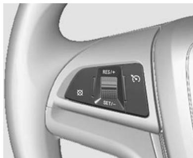
Com o controle de velocidade de cruzeiro, o veículo pode manter uma velocidade de cerca de 23 km/h ou mais sem que você precise manter o pé no acelerador. O controle de velocidade de cruzeiro não funciona em velocidades inferiores a 23 km/h.
