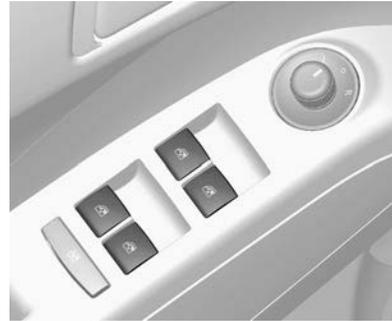
Os vidros elétricos podem ser operados com a ignição nas posições ACC e/ou ON.
