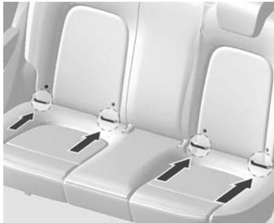
Agora equipamos seu veículo com ancoragens baixas ISOFIX nos dois bancos traseiros externos e com ancoragens superiores no banco traseiro (Sedan- parte traseira dos apoios de cabeça / 5 portas - parte traseira dos painéis dos encostos dos bancos traseiros), permitindo que os sistemas de proteção infantil sejam presos aos bancos traseiros.
