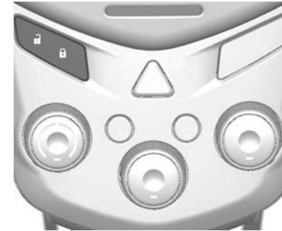
Trava ou destrava todas as portas, a tampa do compartimento de carga (ou tampa do porta-malas) e a porta do bocal de enchimento de combustível.
