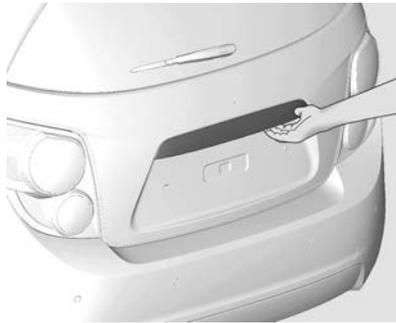
Para abrir a tampa do compartimento de carga, pressione o painel sensível ao toque quando a porta estiver destravada.
