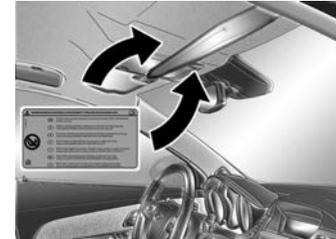
Veículos equipados com Airbag podem ser identificados pela etiqueta autoadesiva no para-sol do lado direito.
