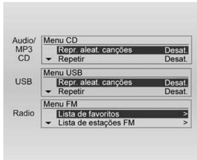
Pressione o botão **MENU-TUNE** para abrir o menu com opções para a função relevante ou o menu do dispositivo relevante (exceto áudio Bluetooth).
