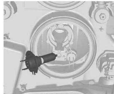
4. Substitua a lâmpada e ligue o conector na lâmpada.
