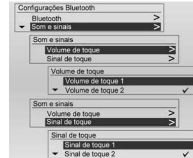
Para ajustar o toque e seu volume, usados pela função Bluetooth, use o botão de controle **MENU-TUNE** para selecionar Som e sinais e, a seguir, ajuste os itens desejados com o botão/controle.
