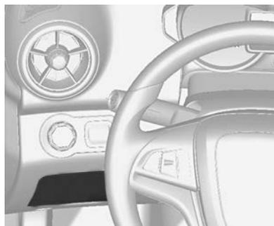
O bloco de fusíveis do painel de instrumentos está localizado na parte inferior do painel de instrumentos do lado do motorista.
