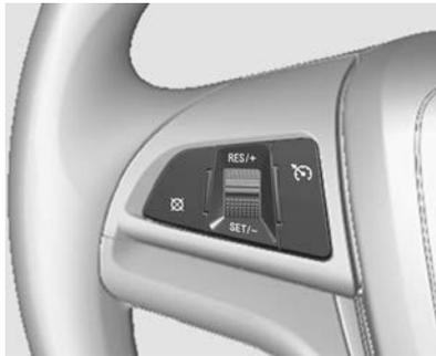
O sistema de controle de velocidade de cruzeiro permite manter a velocidade sem pressionar o pedal do acelerador.
